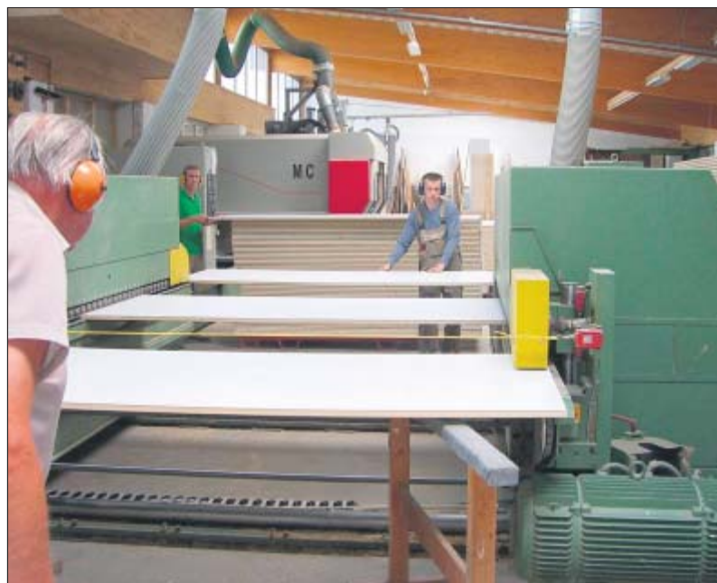
Nur mit Ohrschützern kann in der Schreinerei gearbeitet werden, wenn die Maschinen stundenlang laufen. Das Bild zeigt die einzelnen Trennwände nach dem Schneiden und Pressen.
